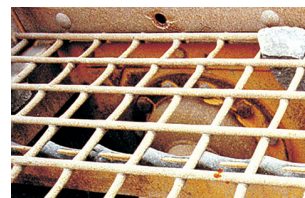
Verschleiß der Längstraversen beim Stahlsiebbelag
