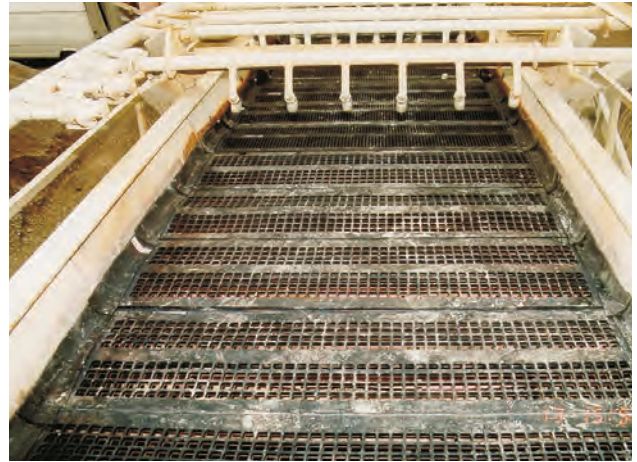
TIP TOP REMASCREEN Siebbeläge halten sich durch große Flexibilität hervorragend sauber.
