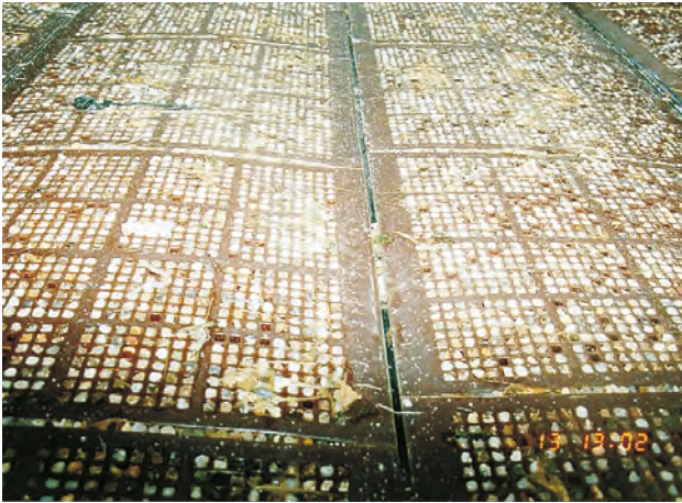
Herkömmliches Modulsystem zeigt fast 100% Steckkorn.
