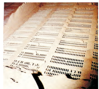
TIP TOP REMASCREEN hält sich durch seine hohe Selbstreinigungskraft nahezu komplett sauber.
