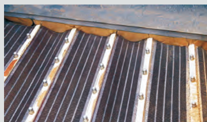
Spannwellen-Siebbeläge mit Befestigungslöchern
