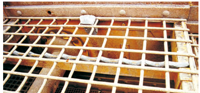
Verschleiß der Längstraversen beim Stahlsiebbelag
